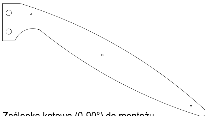
Zaślepka kątowna (0-90°) do montażu profili przed konstrukcją nośną
